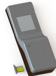
Cómo insertar la bandeja para tarjeta SIM en el dispositivo loA
