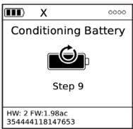
5. Después de que se complete la comprobación y el acondicionamiento de la batería, el dispositivo mostrará la configuración que se obtiene del servidor. El dispositivo mostrará la página de informes predeterminada, tal como se muestra aquí.
