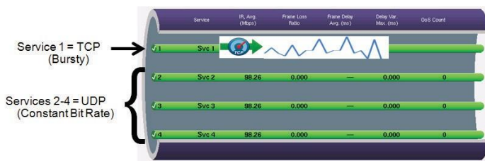
图 19. 含有集成的 TrueSpeed 服务的 Y.1564 性能测试阶段 JDSU 实现的这种集成方法称为 SAMComplete，它是业界唯一将 RFC 6349 与 Y.1564 集成在一起的服务激活方法。SamComplete 提供了 TrueSpeed 服务的自动配置。用户只需要指定 CIR 和 SAMComplete，将自动为网络条件配置适当数量的 TCP 会话。如图 20 所示，在此集成测试结束时，将为用户提供 TrueSpeed 服务的简单通过/失败状态，就像传统的 Y.1564 服务一样。
