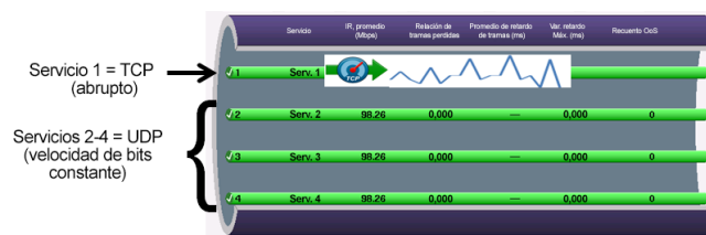
Figura 19. Fase de prueba de rendimiento Y.1564 con servicio TrueSpeed integrado
