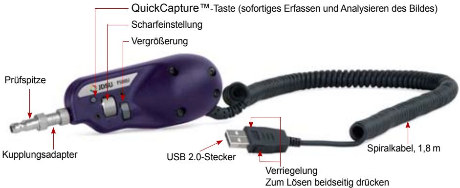
Abb. 14 Bestandteile des Mikroskops P5000i
