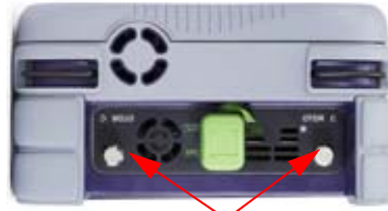
Nicht verlierbare Schrauben zur Befestigung des Moduls
