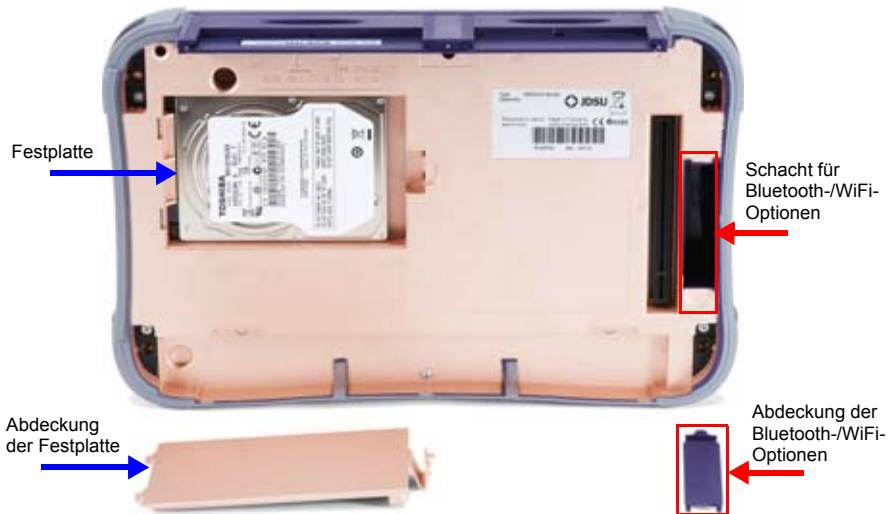
Abb. 88 Einbauposition der Festplatte und der Bluetooth-/WiFi-Optionen
