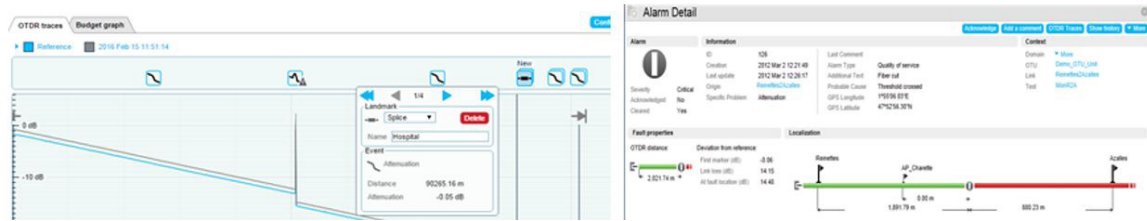
Figura 23: Vista de trazas detallada de OTDR y vista de SLM
