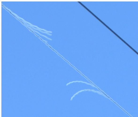
Photo 1b : Éléments de force interrompus
