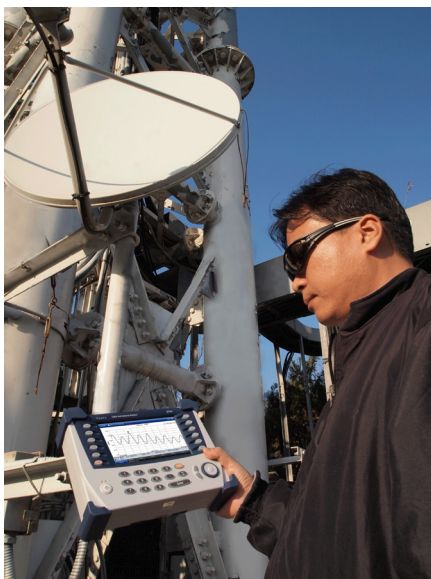
La modalità di visualizzazione per esterni facilita la lettura in presenza di luce solare diretta
