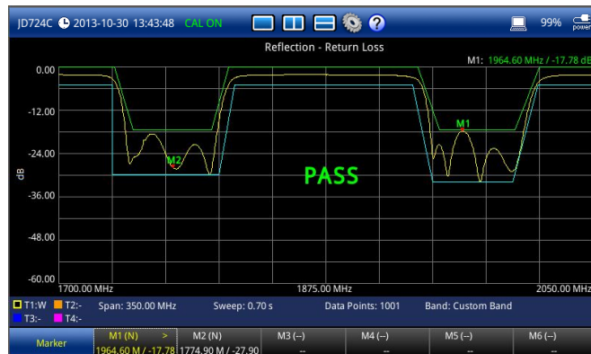
Multi-Segment Limit Line con soglia superiore e inferiore
