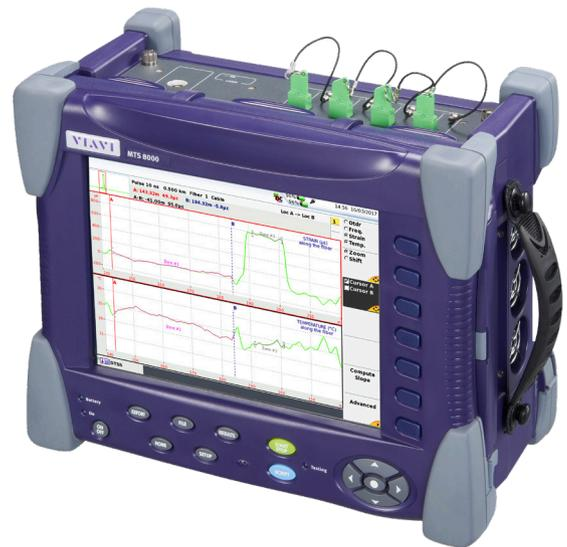
本論文では、バッテリー駆動のフィールド展開可能な計測器に統合された、コヒーレントブリルアン OTDR の斬新な実装について報告します。最初のプロトタイプは、10m の空間分解能を使って 152km で 34dB の総ロスバジェットの敷設された空中リンクの特性評価に使用されました。リンクの両端から2つの OTDR を取得する必要がありますが、これが敷設された通信回線の距離をカバーできる唯一の技術であると主張しています。
