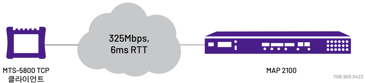
그림 2. TrueSpeed 처리량 테스트 시나리오
