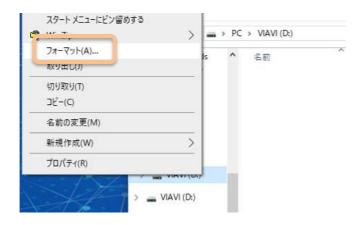
3. PC のフォーマットダイアログにて「デバイスの規定値を復元する(D)」ボタンを押した後「開始(S)」を押し、ダイアログが表示されたら OK を押します。
