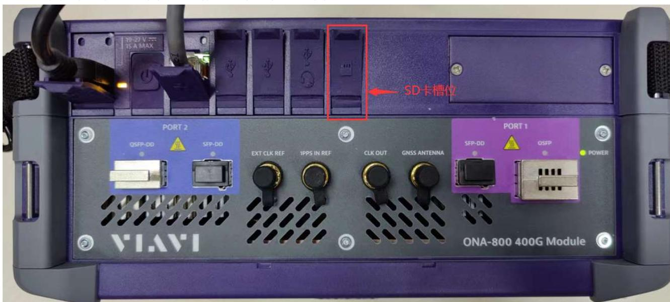
PS, 如果仪表系统恢复失败，则需要检查核对前面的操作步骤，比如：1.SD 卡是否有正确的执行格式化，2.软件包下载是否正确，3.软件包是否正确的解压到了 SD 卡根目录下，4. 重新制作 SD 卡或者更换另一张 SD 卡进行尝试。如确定系统恢复失败，请联系 VIAVI 技术人员做进一步确认，谢谢！
